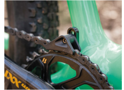
Oben: Die Carbon-Starrgabel baut so hoch wie eine 100-mm-Fork mit 25 Prozent Sag. Die 600-Gramm-Gabel kann man mit und ohne Boost-Laufräder fahren. Unten: Die Mini-Kettenführung macht ohne Federgabel definitiv Sinn.
