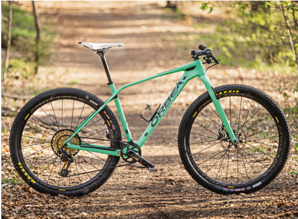
Oben: Die Carbon-Starrgabel baut so hoch wie eine 100-mm-Fork mit 25 Prozent Sag. Die 600-Gramm-Gabel kann man mit und ohne Boost-Laufräder fahren. Unten: Die Mini-Kettenführung macht ohne Federgabel definitiv Sinn.
