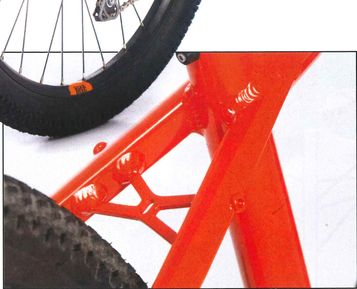
▶ LA TRASERA tiene una separación tal a la rueda que permite usar gomas gruesas de 2.8 pulgadas.
