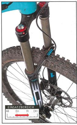
Orbea setzt auf Federelemente von BOS. Die Deville spricht sensibel an mit guter Endprogression. Schade, dass sich die Druckstufe beim Uphill nicht während der Fahrt aktivieren lässt.
