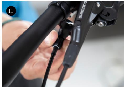
Ajusta la tensión de cable con el ajuste del remoto hasta que la maneta no tenga juego. Tras los primeros usos puede ser necesario volver a ajustar la tensión del cable en la maneta.
