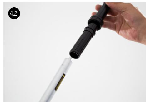
Con una llave Allen de 3mm, desenrosca el prisionero de la parte posterior de la cabeza de la tija y saca el cartucho hidráulico del interior de la tija. Retira los topes de goma del vástago del cartucho. Limpia bien el cartucho con un trapo si vas a volver a usarlo.
