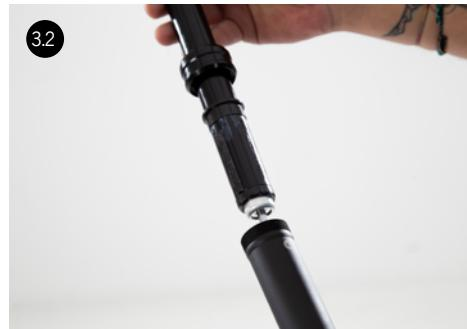
Desenrosca el retén con la mano y separa el conjunto superior de la tija del tubo inferior.
