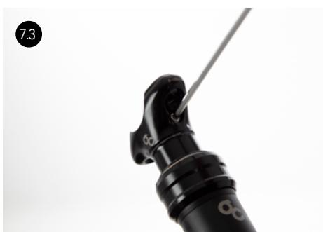
Inserta completamente el cartucho hidráulico dentro de la tija de manera que la muesca del tetón de la parte superior del cartucho quede alineada con el prisionero de la cabeza de la tija.
