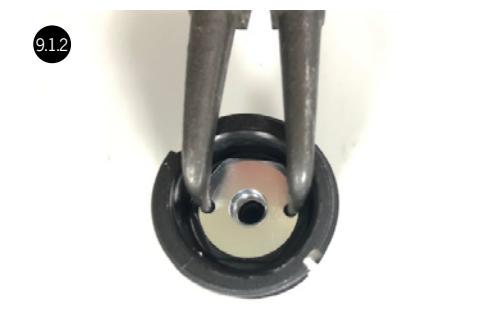
Desliza el tubo inferior hacia arriba y enrosca el conjunto de accionamiento (lee primero los pasos 9.1.1 y 9.1.2). Para evitar dañar la rosca del vástago, primero enrosca un par de vueltas en conjunto de accionamiento en el vástago, luego desliza el tubo inferior hacia abajo y enrosca el conjunto de accionamiento en la base del tubo inferior de la tija. Realiza el apriete final con un llave Allen de 10mm (5Nm).
